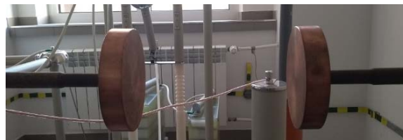
Rys.6. Zdjęcie iskiernika z elektrodami płaskimi. Laboratorium podstaw techniki wysokich napięć WAT.
