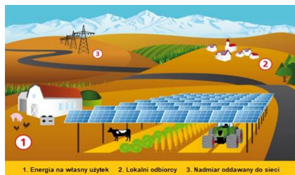
Rys.1. Idea działania systemu agrofotowoltaicznego [14]
