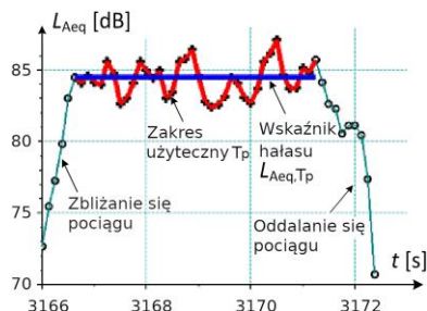
Rys. 5. Wynik obliczenia równoważnego poziomu dźwięku (wskaźnika hałasu) według metodyki opisanej w [12]
