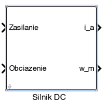
Rys. 1. Model symulacyjny silnika prądu stałego.
