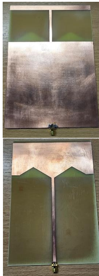
Rys. 2. Wygląd wykonanej mikropaskowej anteny DVB-T2 – widok z przodu i widok z tyłu
