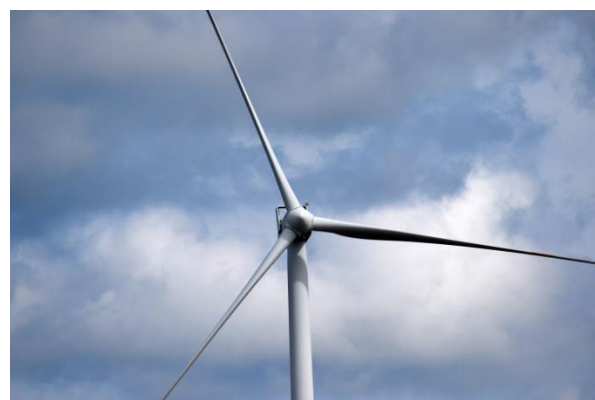
Rys. 2. Łopaty wirnika turbiny ustawione w „chorągiewkę”
