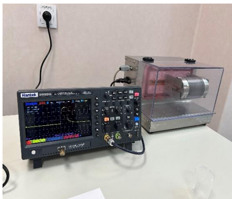
Rys. 1. Widok komory oddziaływania PEF wraz z rejestracją impulsu na oscyloskopie
