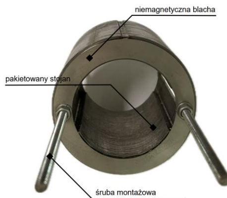
Rys.9. Stojan silnika komutatorowego wzbudzanego magnesami neodymowymi prostopadłościennymi
