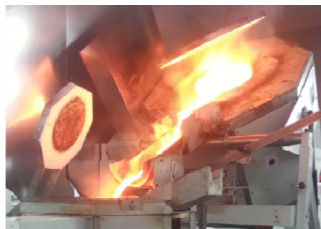
Rys.9. Topienie w piecu indukcyjnym
