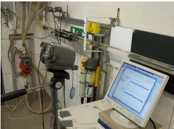
Rys. 2. Sekcja pomiarowa instalacji hydraulicznej do badania przepływów metodami radioizotopowymi w Akademii Górniczo-Hutniczej w Krakowie
