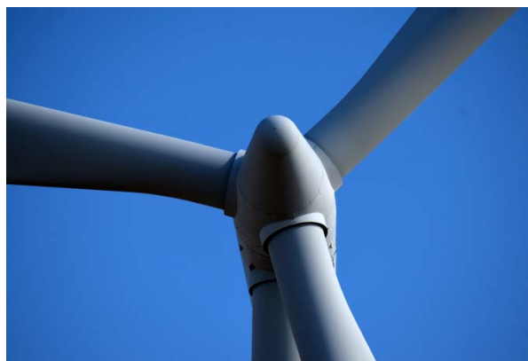
Rys. 1. Wirnik turbiny z łopatami z regulowanym kątem natarcia
