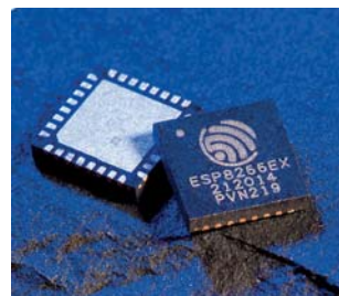
Rys. 4. „Sprawca” rewolucji w IoT – układ ESP8266EX [5]
