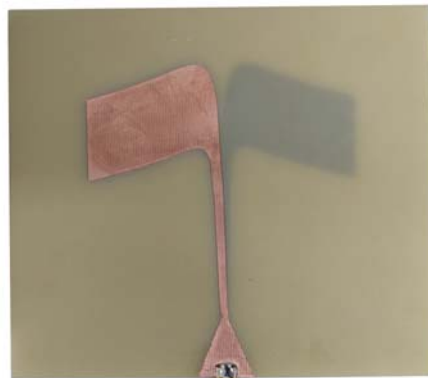
Rys. 8. Fotografia jednego ze zrealizowanych modeli anteny (wersja z krótkim transformatorem)
