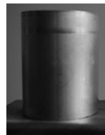
Rys.2. Formowany aluminiowy wsad rurowy – półwyrob
