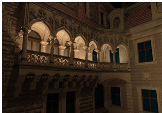
Rys.9. Komputerowa wizualizacja iluminacji wnętrza krużganków obiektu architektonicznego, a – wariant z uwzględnieniem wyłącznie składowej bezpośredniej strumienia świetlnego baterii naświetlaczy, b – wariant z uwzględnieniem odbić wielokrotnych strumienia świetlnego baterii naświetlaczy
