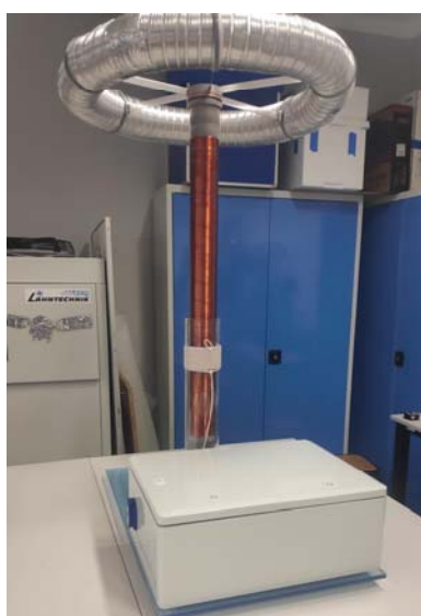
Rys. 12. Zmontowany układ do zasilania i sterowania cewką Tesli.
