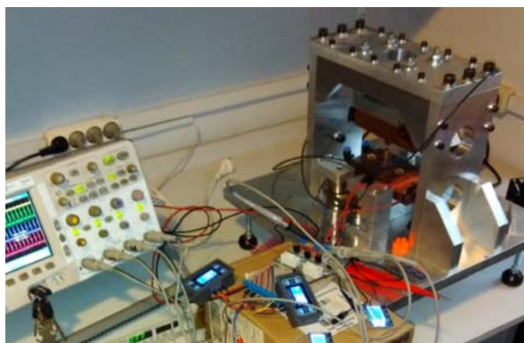
Rys. 4. Oprzyrządowane stanowisko do badania siły docisku
