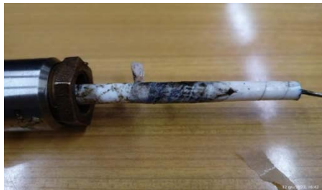
Rys. 12 Uszkodzony rdzeń izolatora
