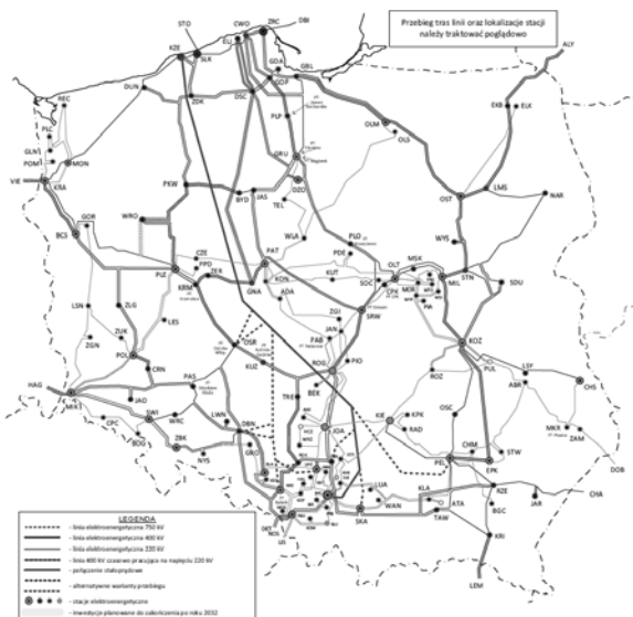
Rys. 1. Układ sieci przesyłowej planowany na 2032 rok według planu rozwoju opracowanego przez krajowego OSP [1]
