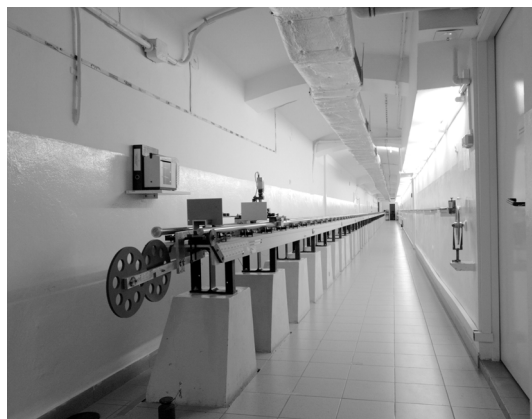
Rys. 1. Stanowisko pomiarowe 50 m komparatora interferencyjnego umieszczonego w klimatyzowanym korytarzu w podziemiach Głównego Urzędu Miar
