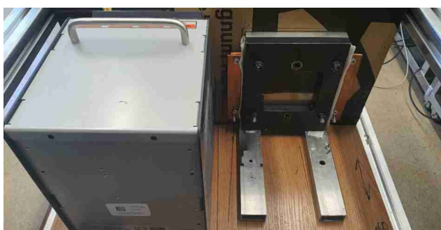
Rys. 3. Widok stanowiska od strony podłączenia czujników termoelektrycznych, z lewej strony pokazano kalibrator do kamer termowizyjnych
