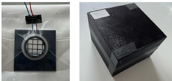
Rys.2. Zdjęcie detektora na bazie panelu fotowoltaicznego oraz scyntylatora w hermetycznym rękawie oraz w obudowie wykonanej w technice druku 3D.
