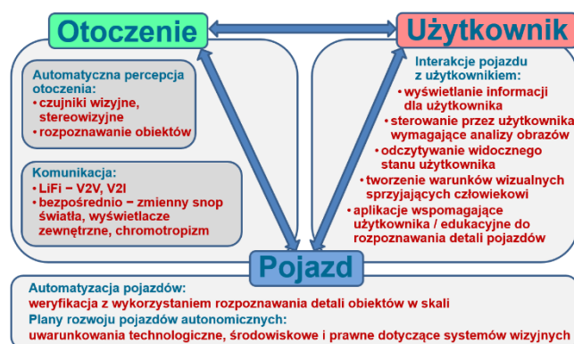
Rys. 1. Sygnaly wizyjne w modelu automatyzacji pojazdów (na podstawie pracy [4])
