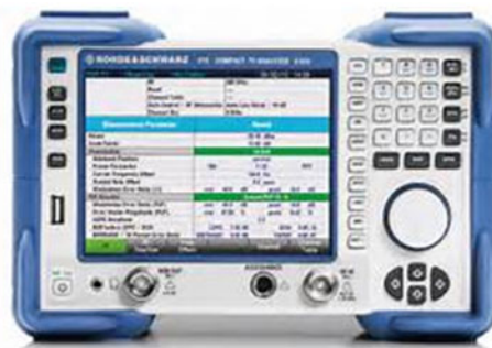
Rys.1. R&S@ETC Compact TV Analyzer [model 2116.500K08] nr ser. 101235-XU – odbiornik sygnału telewizyjnego DVB-T/T2
