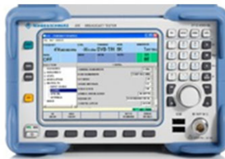
Rys.2. R&S@SFE Broadcast Tester [model 2112.4300.02] nr ser. 100113 – nadajnik sygnału telewizyjnego DVB-T/T2
