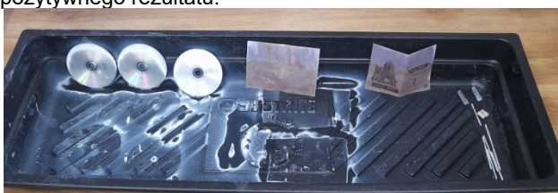
Rys. 4. Dekontaminacja powierzchni płyt CD za pomocą proszku SX34. [7]
