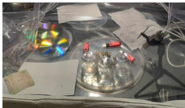
Rys. 5. Dekontaminacja nośników śladów w komorze z użyciem gazowego nadtlenu wodoru. Po prawej stronie na trójnogu widoczne są czujniki: stężenia nadtlenu wodoru, temperatury oraz wilgotności. [7]
