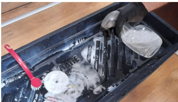
Rys. 3. Dekontaminacja powierzchni płyt CD za pomocą pian CHEM, BIO oraz RAD. [7]
