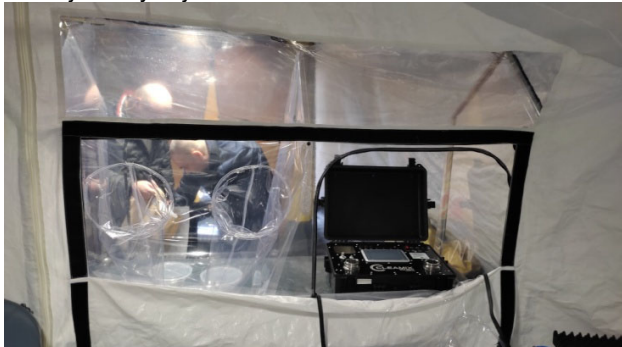
Rys. 1. Widok, od strony czystej namiotu, komory do dekontaminacji śladów kryminalistycznych. Po prawej stronie widoczna jest otwarta śluza, która jest zamknięta w trakcie dekontaminacji. W śluzie znajduje się druga para rękawic umożliwiających bezpieczną pracę z ujawnionymi śladami. [7]
