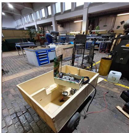
Rys. 21. Prototyp mobilnego systemu zasilania statków powietrznych i systemów łączności zbudowany w Zakładzie Produkcji Prototypowej ITWL
