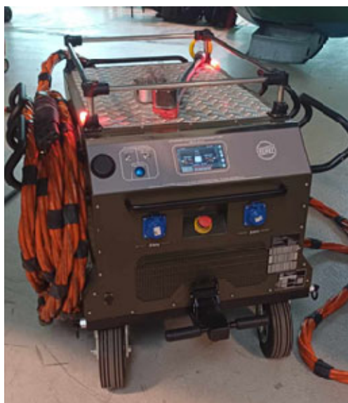
Rys. 11. Agregat LZE-6 – zasilacz tyrystorowy skonstruowany przez ITWL i produkowany przez WCBKT
