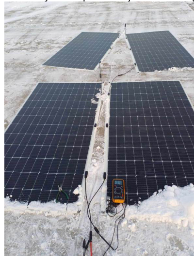
Rys. 16. Panele fotowoltaiczne elastyczne podczas badań na zaśnieżonej płycie lądowiska na terenie ITWL
