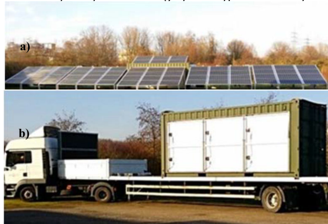
Rys. 4. Zestaw paneli fotowoltaicznych typu MC66, będący na wyposażeniu Bundeswehry [5] a) rozwinięty b) podczas transportu
