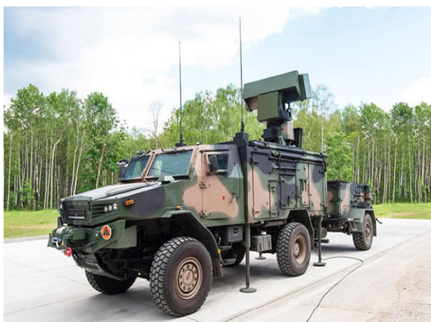
Rys. 6. Stacja radiolokacyjna Bystra to w ogromnym uproszczeniu nieduży przeciwlotniczy radar umieszczony na podwoziu samochodu terenowego Żubr (z firmy AMZ Kutno) – na zdjęciu widoczny holowany agregat prądowłóczy [materiały reklamowe WZŁ-1 Zegrze]
