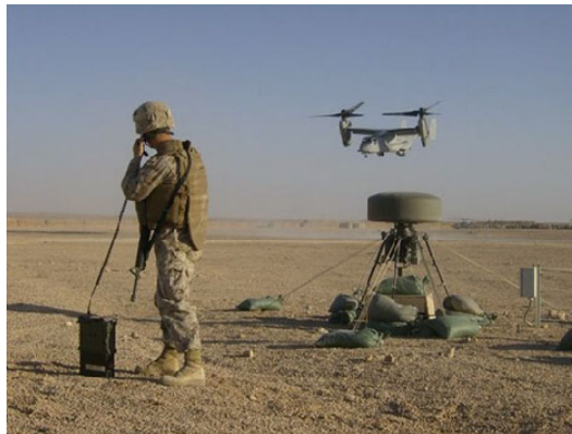
Rys. 7. Rozstawianie systemu TACAN na lotnisku polowym
