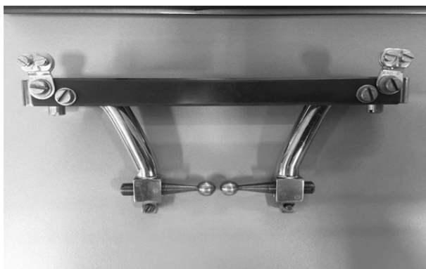
Rys.2. Widok układu elektrod kulowych wraz z systemem mocującym
