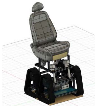
Rys. 2. Model wózka inwalidzkiego o napędzie gąsienicowym wraz z systemem autopozymowania siedziska wykonany w programie Fusion 360
