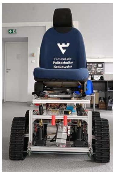
Rys. 9. Prototyp wózka inwalidzkiego o napędzie gąsienicowym wraz z systemem autopozjomowania siedziska ze zmiennym fotelem
