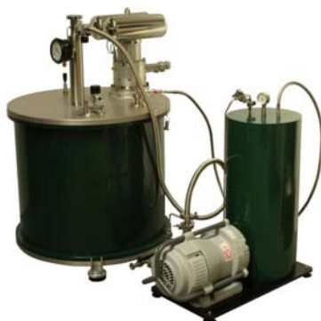
Rys.1. System do pomiaru efektu Halla z magnesem nadprzewodzącym, chłodzonym w systemie z zamkniętym obiegiem helu (ang. cryo-free ) [15]
