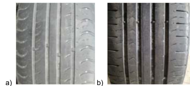
Rys. 5. Przykładowe zdjęcia opon: a) ze zużyтым, b) z właściwym stanem bieżnika
