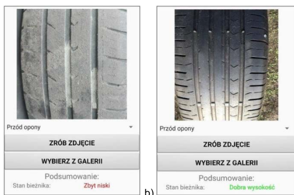
Rys. 8. Zrzut ekranu wyników testu dla zdjęcia opony w widoku z przodu: a) zbyt niski poziom bieżnika, b) właściwy poziom bieżnika
