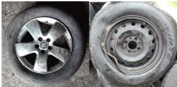
Rys. 3. Przykładowe zdjęcia uszkodzonych kół
