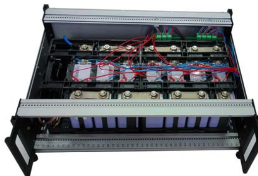
Rys. 1. Praktyczna realizacja modelu magazynu energii „24 V”
