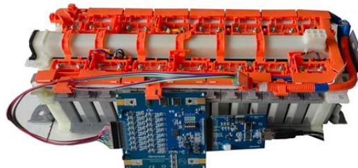
Rys. 6. Praktyczna realizacja modelu magazynu energii „48 V”
