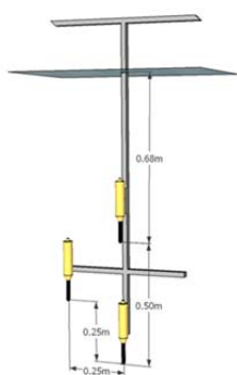
Rys.5. Rysunek poglądowy zestaw hydrofonów odbiorczych
