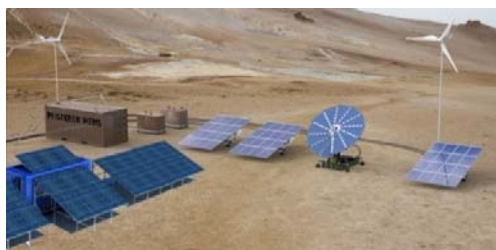
Rys. 5. Mobilny hybrydowy system zarządzania energią [1638].
