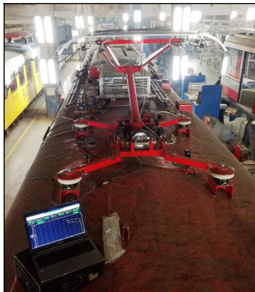
Rys.5. Widok odbieraka typu DSA 150.06 podczas badań statycznych
