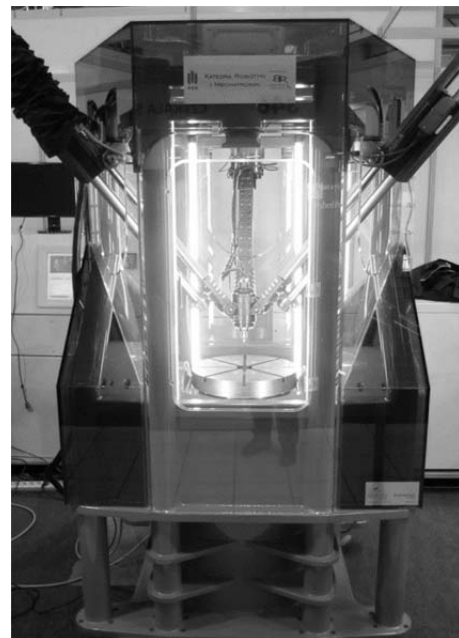
Rys.1. Prototyp pięcioosiowego robota hybrydowego
