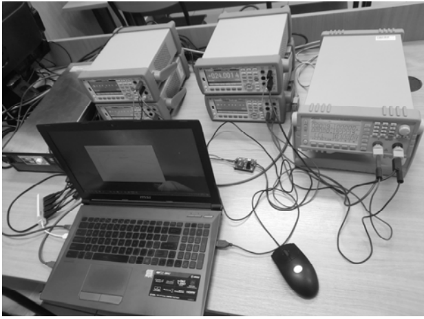
Rys.2. Stanowisko pomiarowe do badania przetwornic DC/DC oraz liniowych stabilizatorów napięcia
