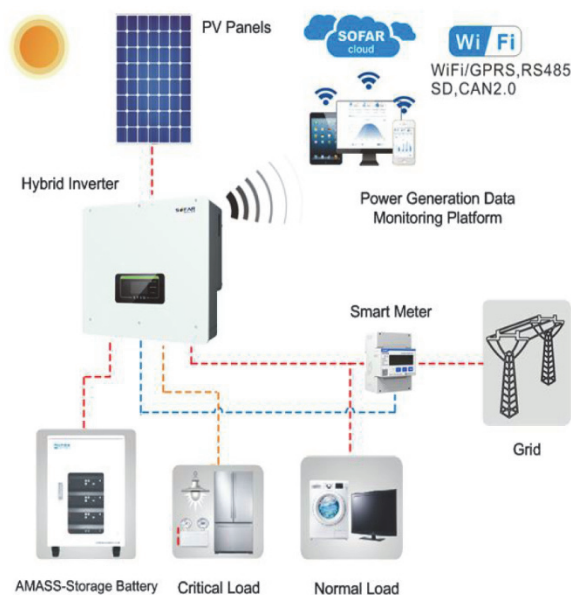
Rys. 4. Schemat ideowy inwertera Sofar Solar wraz z bateriami oraz innymi elementami systemu fotowoltaicznego i instalacji elektrycznej dla gospodarstwa domowego [8]
