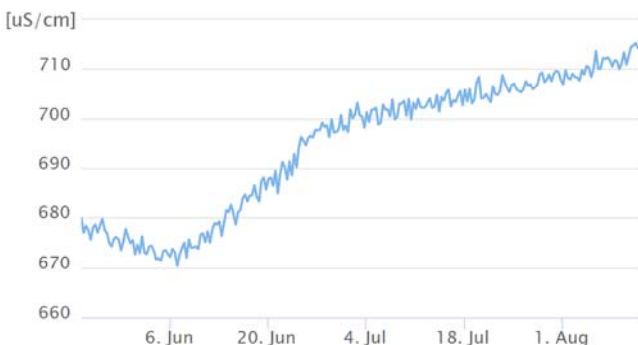
Rys.5. Konduktancja wody w piezometrze otwartym zarejestrowana w okresie od 24 maja do 11 sierpnia 2022 roku
