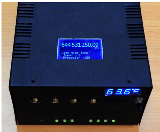
Rys.8. Widok zewnętrzny zestawu mierzącego pożądaną wartość 644,53125 MHz syntezowaną z 30,72 MHz z LEA-M8F i Si5338A
