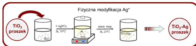
Rys.3. Schemat modyfikacji „fizycznej” \text{TiO}_2 atomami srebra
