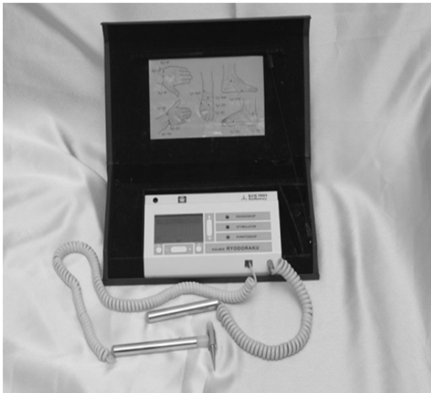
Rys.2. Urządzenie do pomiaru aktywności elektrodermalnej (EDA) firmy Kolmio-Kielkowsky
