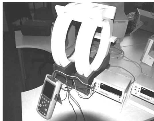
Rys.1. Stanowisko do badań materiałów biologicznych poddawanych ekspozycji w przemiennym polu magnetycznym o częstotliwości 50 Hz o regulowanym natężeniu
