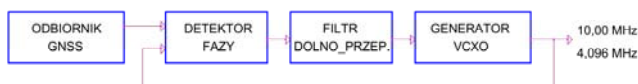
Rys.13. Układ badawczy generatora VCXO w układzie pętli fazowej PLL synchronizowanej przez odbiornik GNSS
