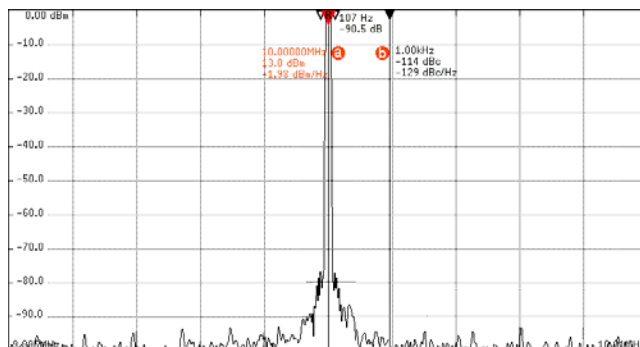
Rys.22. Spektrogram sygnału o częstotliwości 10 MHz na wyjściu układu Si5317 w trybie podtrzymania
