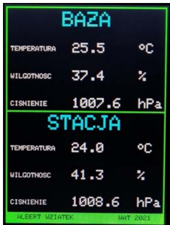
Rys.2. Graficzny interfejs stacji domowej przedstawiony na LCD
