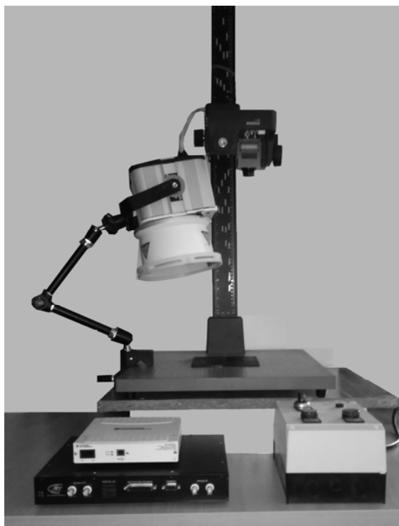
Rys. 2. Stanowisko do badań nieniszczących z zastosowaniem aktywnej termografii przy użyciu lampy halogenowej o mocy 2,5 kW
