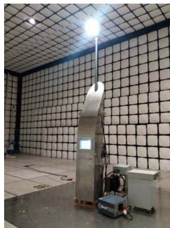
Rys. 4. Zdjęcie stacji ładowania z pomiarów emisji elektromagnetycznej w komorze ekranowej
