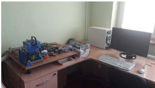
Fot.1. Stanowisko laboratoryjne z przetwornicą DC-DC obniżającą napięcie i kartą dSpace
