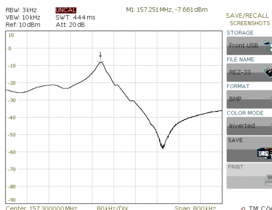
Rys. 15. Amplitudowa charakterystyka częstotliwościowa ustroju pomiarowego czujnika z AFP
