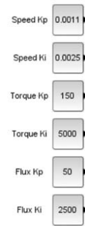
Rys. 10. Nastawy regulatorów w układach regulacji prędkości obrotowej wału silnika, momentu obrotowego i strumienia wzbudzenia.
