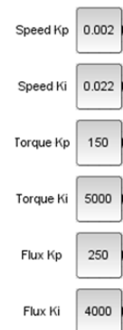
Rys. 12. Nastawy regulatorów w układach regulacyjnych napędu obowiązujące w czasie wspomnianej wyżej jego próby obciążeniowej.
