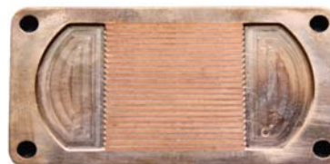
Rys.9. Koncepcja integracji mikrokanalowej struktury chłodzącej z konwerterem (a) oraz widok wykonanej struktury chłodzącej (b)
