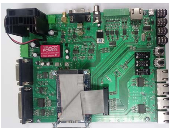
Rys.2. Sterownik stanowiska do badania algorytmów komutacji napędów bezpośrednich
