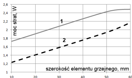
Rys. 8. Moc strat ciepłych w funkcji wymiarów elementu grzejnego dla modelu wykorzystującego zalewę termoprzewodzącą (1) oraz powietrze (2) jako medium między ogniwami
